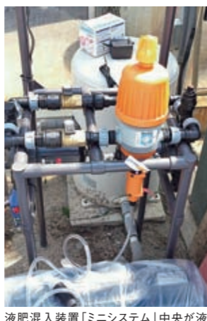
液肥混入装置「ミニシステム」中央が液肥混入器「ミックスライト」
