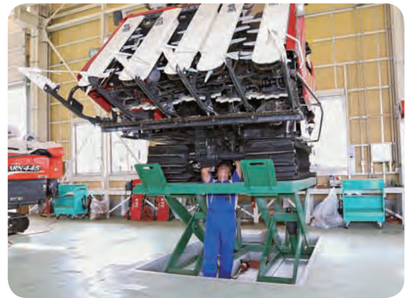
油圧リフトを用いた整備作業
