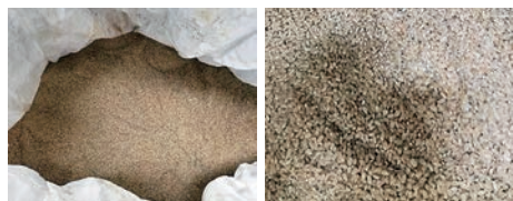
フレコン内部にカビ発生
