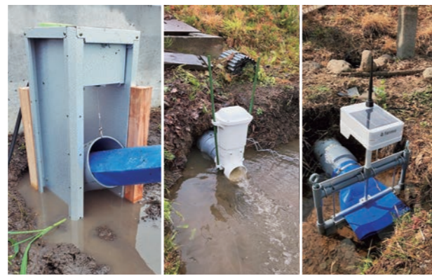
試験を行った自動給水機3種 (農匠自動給水機・AquaPort・farmo給水ゲート)
