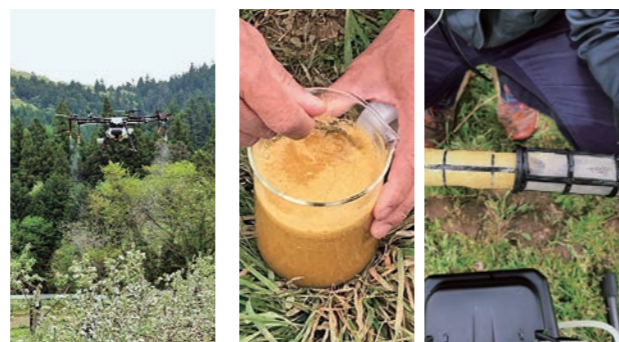
MG-1SAによるリンゴ花粉散布 リンゴ花粉溶液と散布後のフィルター
