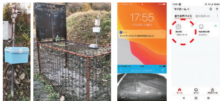
ICT捕獲システム(カメラ+通信機器+ 通知とライブ映像 罠作動装置) スマートフォンで遠隔操作
