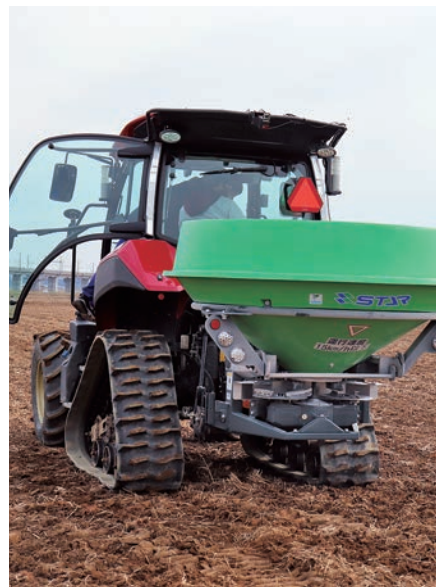
可変施肥対応の散布機 (GPSナビキャスト)
