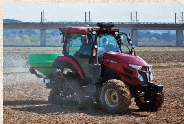
「GPSナビキャスト」を搭載したトラクターで可変施肥を行なっている様子
