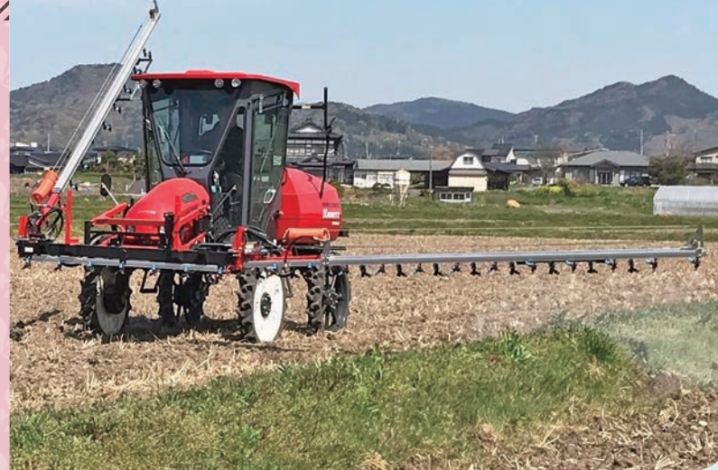
写真2 ハイクリによる除草剤散布(先端2~3のノズルで散布)
