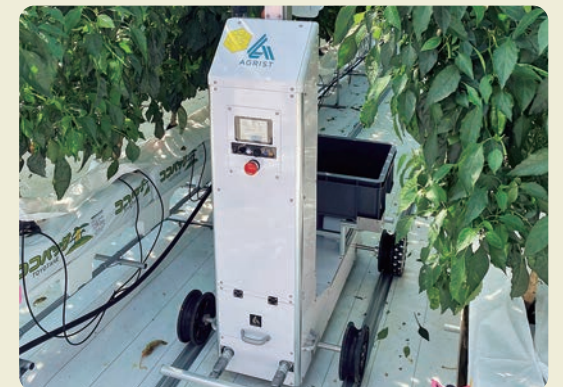
先進園芸実証農場 ピーマン自動収穫ロボット
