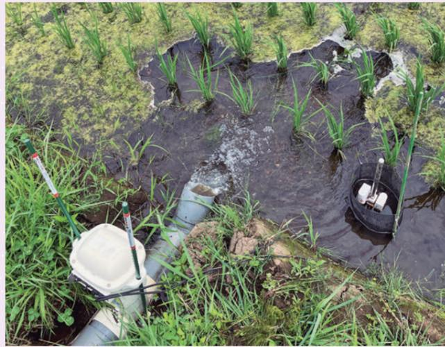
図1 アクアポート設置例。センサー部分は藻の影響を受けないよう、周囲に鉢底ネットを設置
